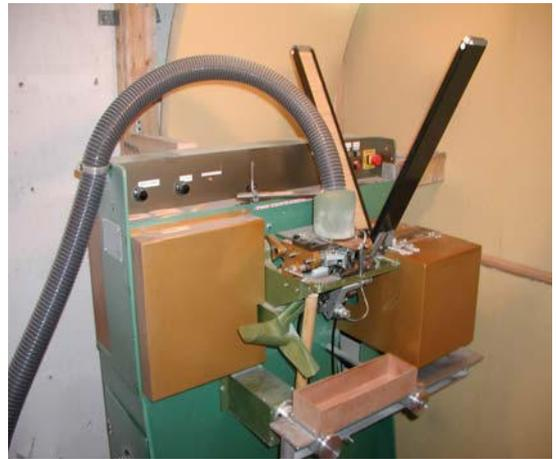
Abbildung 2.13: Vollautomatische Hobelmaschine
