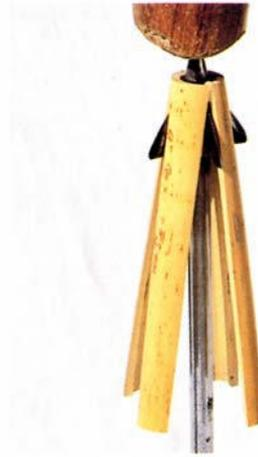
Abbildung 2.9: Vierteln des Rohrholzes
